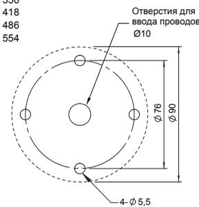
▲ Монтажное крепёжное отверстие пластикового корпуса
