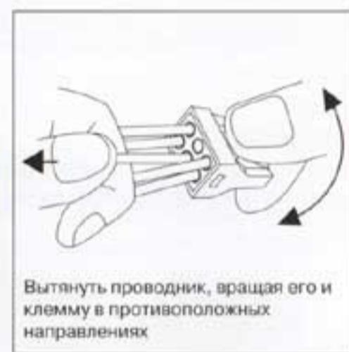
Вытянуть проводник, вращая его и клемму в противоположных направлениях
